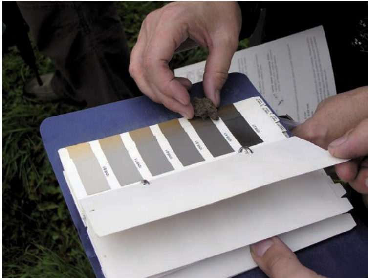
Farbbestimmung mit Hilfe der Munsell-Skala
