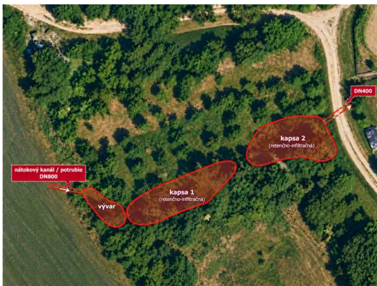
Obr. 3. Ilustračná vizualizácia priestorového usporiadania systému po terénnom zameraní. Geometrické výpočty v tomto dokumente nevychádzajú z tejto vizualizácie, ale z GPS bodov a DMR 6.0.
